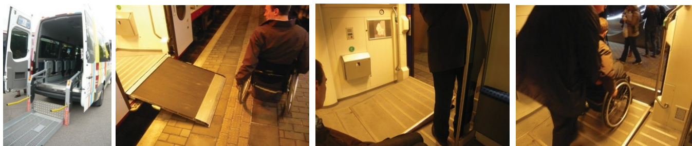
Foto: Tecnologie per migliorare la mobilità delle persone su sedia a ruote: sollevatore e rampa per superare il dislivello tra la piattaforma e il treno (© Lorenzo Lucchini, 2013)
